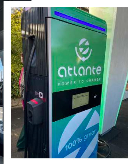
DUE ESEMPI DI COLONNINE ULTRAFAST E FAST TRA LE PIÙ DIFFUSE. QUELLA DI FREE TO X È UN HYPERCHARGER ALPTRONIC CON 4 PUSH BUTTON CHE CONSENTONO DI NAVIGARE TRA LE VARIE FUNZIONI. MENTRE LA WALLBOX SUPERNOVA DI ATLANTE PREVEDE LA PRESENZA DI UNO SCHERMO TOUCHSCREEN
