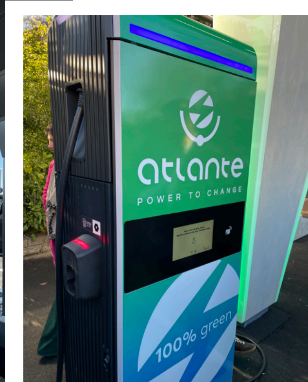
DUE ESEMPI DI COLONNINE ULTRAFAST E FAST TRA LE PIÙ DIFFUSE. QUELLA DI FREE TO X È UN HYPERCHARGER ALPITRONIC CON 4 PUSH BUTTON CHE CONSENTONO DI NAVIGARE TRA LE VARIE FUNZIONI. MENTRE LA WALLBOX SUPERNOVA DI ATLANTE PREVEDE LA PRESENZA DI UNO SCHERMO TOUCHSCREEN
